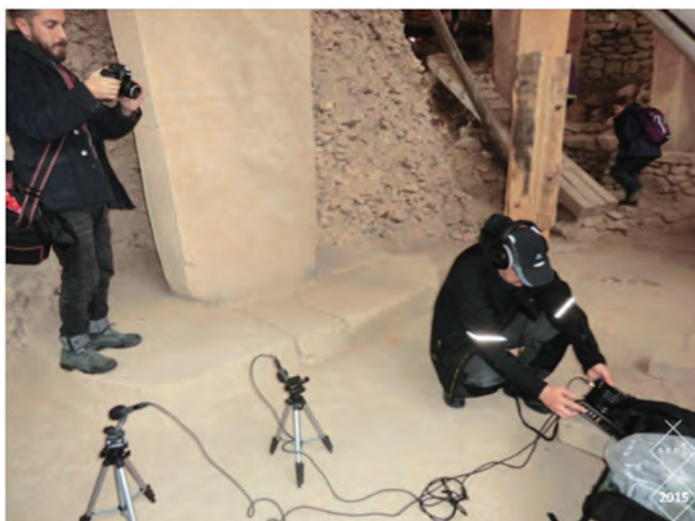
Εικόνα 2: Η εγκατάσταση για την καταγραφή των ήχων: η συσκευή ηχογράφησης Tascam DR-680 και τα μικρόφωνα Sennheiser MKH 8020 στο Κύκλωμα D του αρχαιολογικού τόπου Göbekli Tepe (Νοτιοανατολική Ανατολία).
