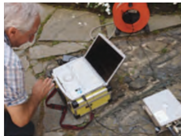
Εικόνα 8: Αριστερά: GeoBox SR04S3. Δεξιά: η συσκευή συνδεδεμένη με κάποιον υπολογιστή εν λειτουργία.
