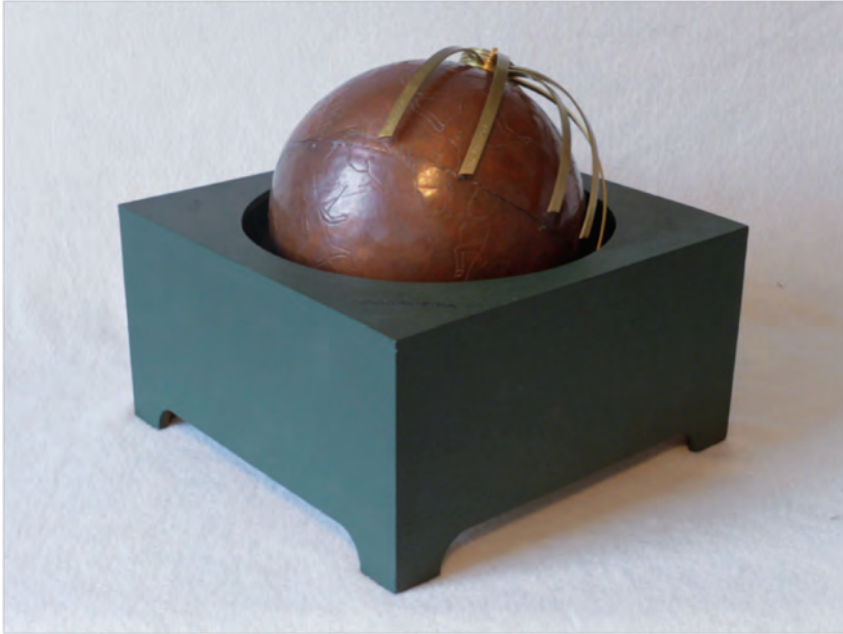
Εικόνα 1: Η «Σφαίρα του Αρχιμήδους»: οι ενδείκτες σαρώνων γύρω από την Εκλειπτική, η οποία αντιστοιχεί στη σύνδεση μεταξύ των ημισφαιρίων.
