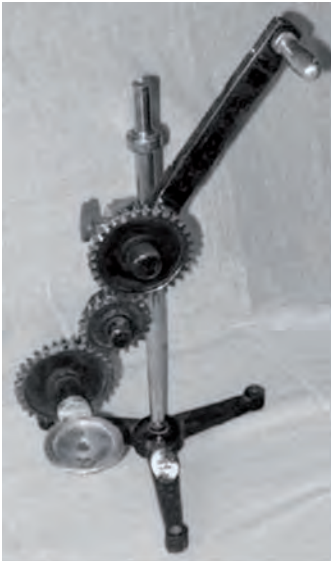
Εικόνα 4: Πλανητικός συρμός Ferguson: Μοντέλο Νο 9 (α) φωτογραφία του μοντέλου β) σχέδιο [7].
