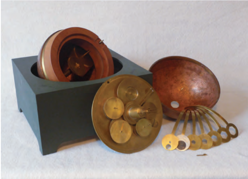
Εικόνα 4: Η «Σφαίρα του Αρχιμήδους»: ο πλανητικός μηχανισμός έχει αφαιρεθεί για να δείξει τον κινητήριο οδοντωτό τροχό κάτω απ' αυτόν.
