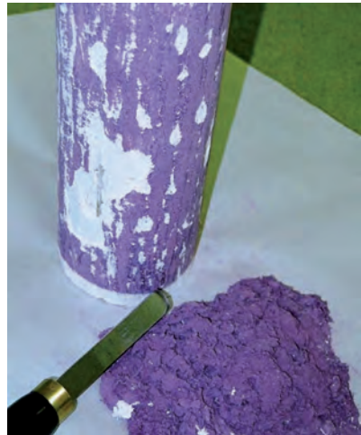
Κρουστική δοκιμή με σφύρα, στα λευκά μέρη η πορφύρα αφαιρέθηκε με σμίλη.
