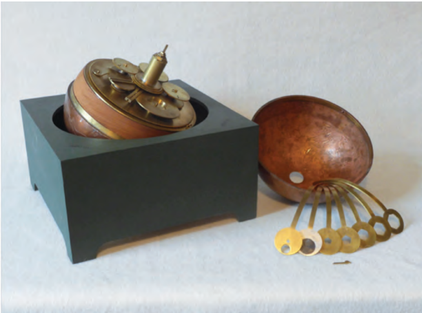
Εικόνα 3: Η «Σφαίρα του Αρχιμήδους»: το άνω ημισφαίριο έχει αφαιρεθεί για να αποκαλύψει τον εσωτερικό μηχανισμό στη θέση του.
